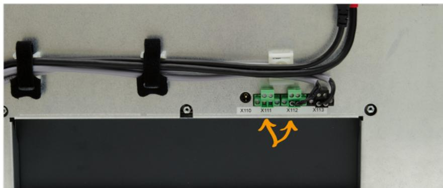
Legen Sie die Adern anschließend an einer der freien Klemmen auf. Verwenden Sie hierfür Aderendhülsen mit Kragen. Der maximale Aderquerschnitt ist 1,5mm<sup>2</sup>.
