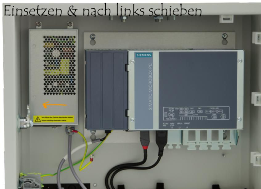
4. Schließen Sie die Erdungsleitung an eine der freien Erdungsklemmen auf der Hutschiene an.
