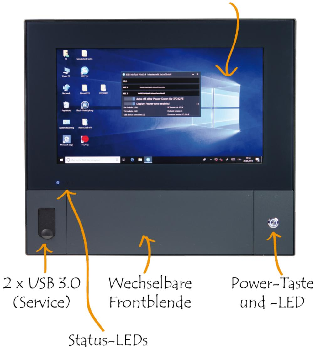
Die Fronteinheit enthält einen 4x USB3.0-Hub, der mit dem PC verbunden ist. Diese USB-Ports sind wie folgt verwendet:
